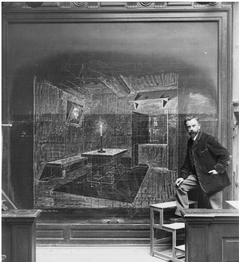
fig. 25 Max Kleiber. Studio delle ombre in un interno con una candela come sorgente luminosa propria (o finita). Bildarchiv, Foto Marburg
